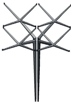
Figure 2. Famille Revit® créée pour la représentation des arbres métalliques
