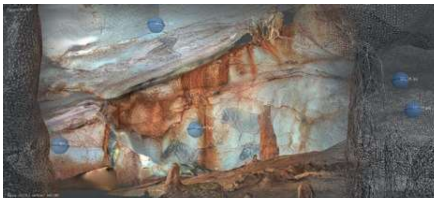
Figure 13. Texturation du modèle maillé 3D du secteur 101 (panneau des chevaux) réalisée sous Agisoft Metashape à partir des images panoramiques acquises par le scanner.
