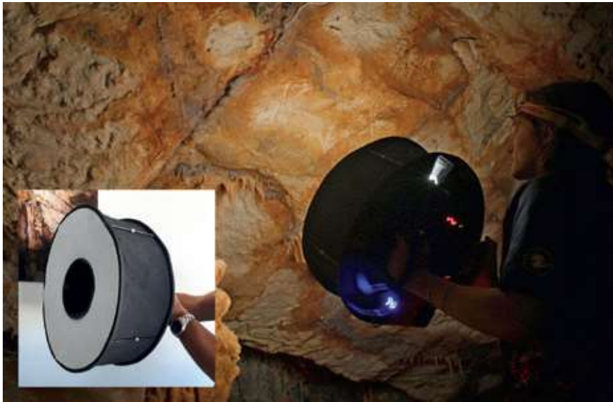
Figure 14. Le système de prise de vue photogrammétrique et son diffuseur annulaire mis en œuvre dans la grotte Cosquer.
