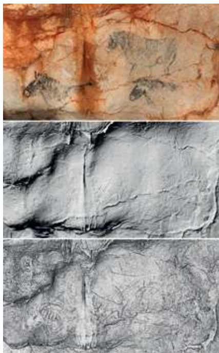
Figure 16. Panneau des chevaux 2020 : orthophotographie, GRID MNT ombré et GRID MNT des microreliefs.
