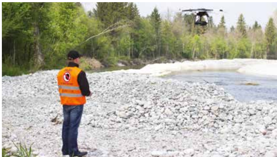
Figure 10. Le relevé de la rivière par drone Aibot X6
