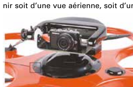
Figure 2bis. Vue avec la nacelle supérieure surtout utile pour les inspections
